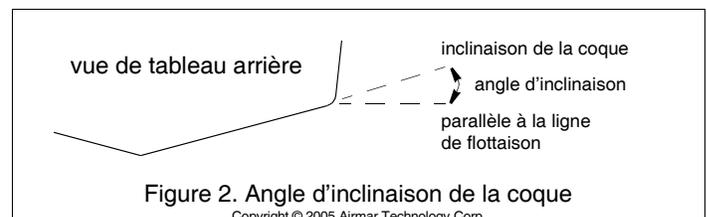
Figure 2. Angle d'inclinaison de la coque
