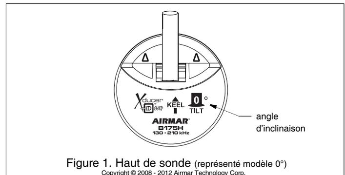
Figure 1. Haut de sonde (représenté modèle 0°)
