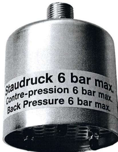
Schalldämpfer dienen zur Geräuschminde rung an pneumatischen Anlagen. Nach verrichteter Arbeit in geschlossenen Systemen erfolgt das Abblasen grosser Durchflussmengen in die Atmosphäre. Die rasche Entlüftung und die Entspannung auf Normaldruck bei gleichzeitiger Schalldämpfung wird durch die optimale Anordnung der Filzscheiben und Lochscheiben erreicht (Drossel- und Absorptionsprinzip).
