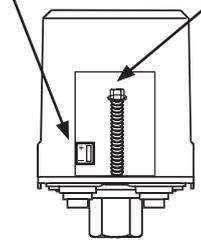
Regolazione della pressione di attacco: avvitando aumenta il valore di pressione
